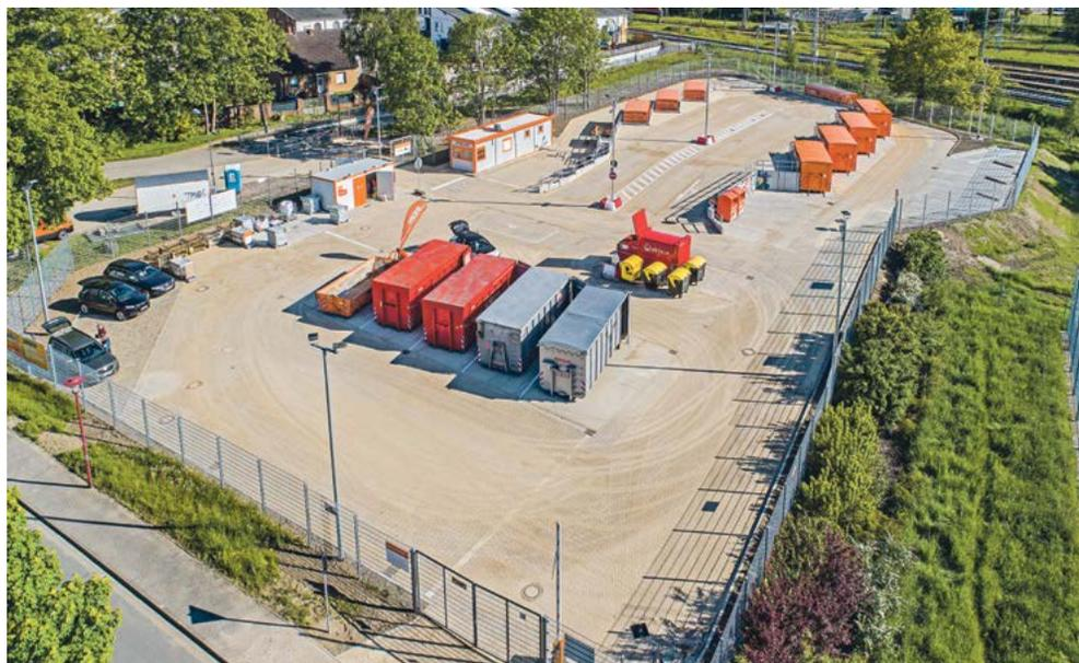
Abfallcontainer werden von der Plattform seitlich angefahren und die Abfälle von einem Plateau in die Container befüllt. Die Verkehrsführung auf der Plattform erfolgt U-förmig und ist somit kreuzungsfrei.
